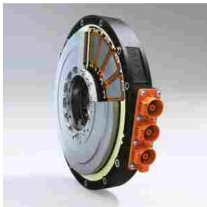
*Un motore elettrico Yasa a flusso assiale. I rotor sottili e di grande diametro impediscono un regime di rotazione molto elevato ma danno una grande coppia. Il favorevolissimo rapporto volume/potenza ha convinto Ferrari ad adottarlo per le sue ibride e ha indotto Mercedes-Benz ad acquisire l'azienda*
