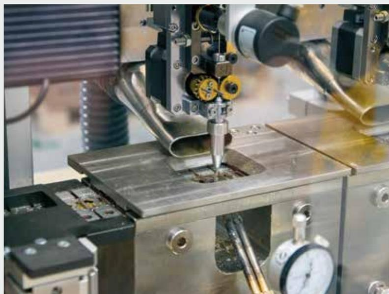
Deposito di stagno sulla zona di fusione della lamina.
