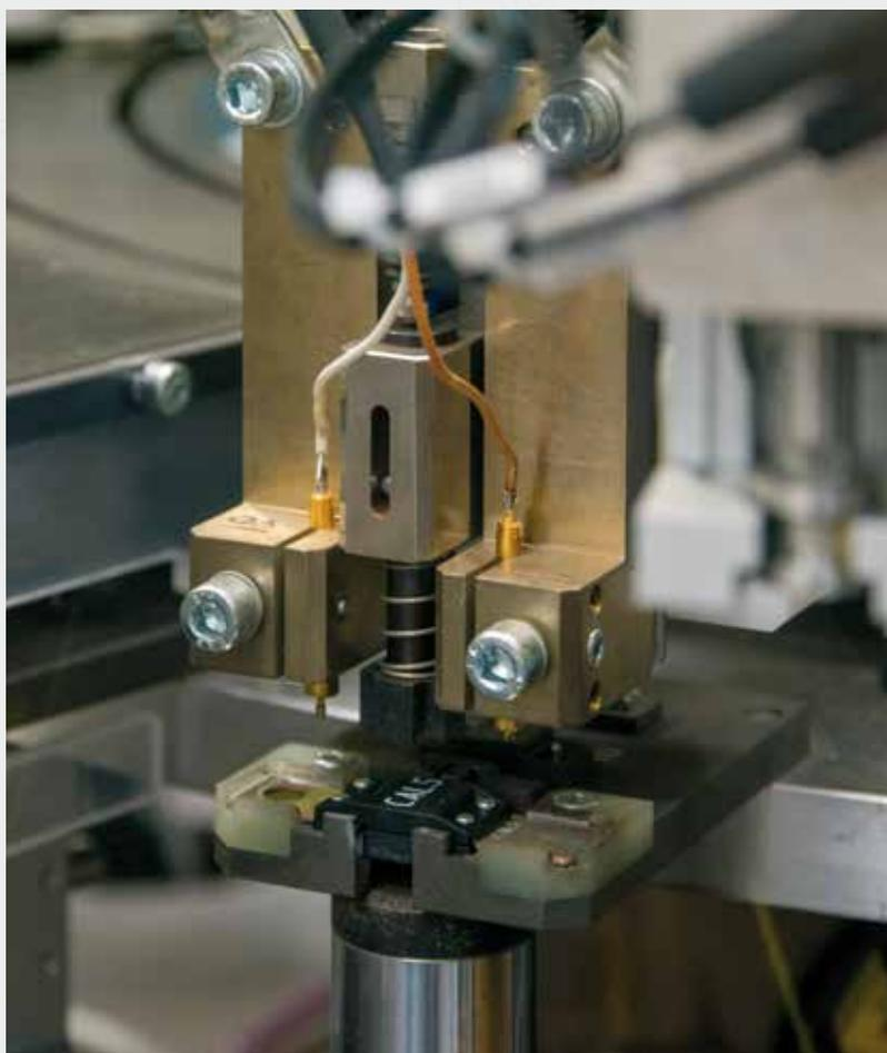
Test di caduta di tensione dopo l'assemblaggio, per la verifica della congruenza con parametri predefiniti a disegno.
