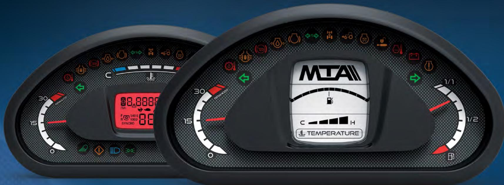
clock; 1 buzzer; 1 linea Can con terminazione configurabile; fino a 23 ingressi digitali configurabili; 2 ingressi analogici; 2 frequenziali e 1 uscita da 500 mA. Il vetro del cluster strumenti è realizzato in PMMA. Quik può operare sia a 12V sia a 24V e il sistema di fissaggio prevede due possibili opzioni, con o senza cornice frontale.
