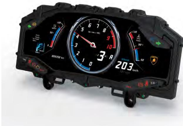
件支持的情况下实现仪表板的新功能。这就是我们公司决定采用德州仪器最新一代图形处理器 Jacinto 5 的原因所在。此款多核微处理器配备有一个专用于 HMI(人机界面)任务的中央内核以及其他通用内核,这些内核并行运行,可加快它们对任务的分配速度。仪表板的 3D 图形显示提供了多种不同配置选项。驾驶员可在三种不同
