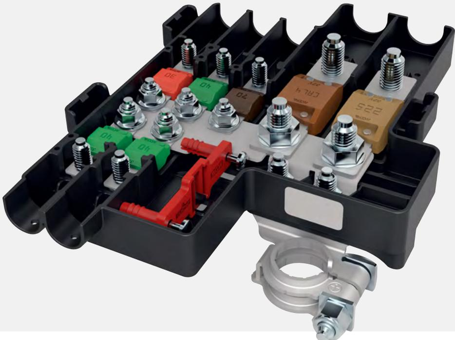
La nuova centralina PDU sviluppata da MTA Brasil soddisfa una specifica necessità di FIASA, quella cioè di avere un lay-out che prevede un'uscita cavi sopra la batteria montata su una nuova piattaforma di vetture. Questa centralina di distribuzione della potenza può ospitare 2 fusibili Megaval/Powerval + 5 midival e protegge il motorino di avviamento e altri dispositivi quali l'ABS, obbligatorio in Brasile sulle nuove vetture a partire dal 2014.
