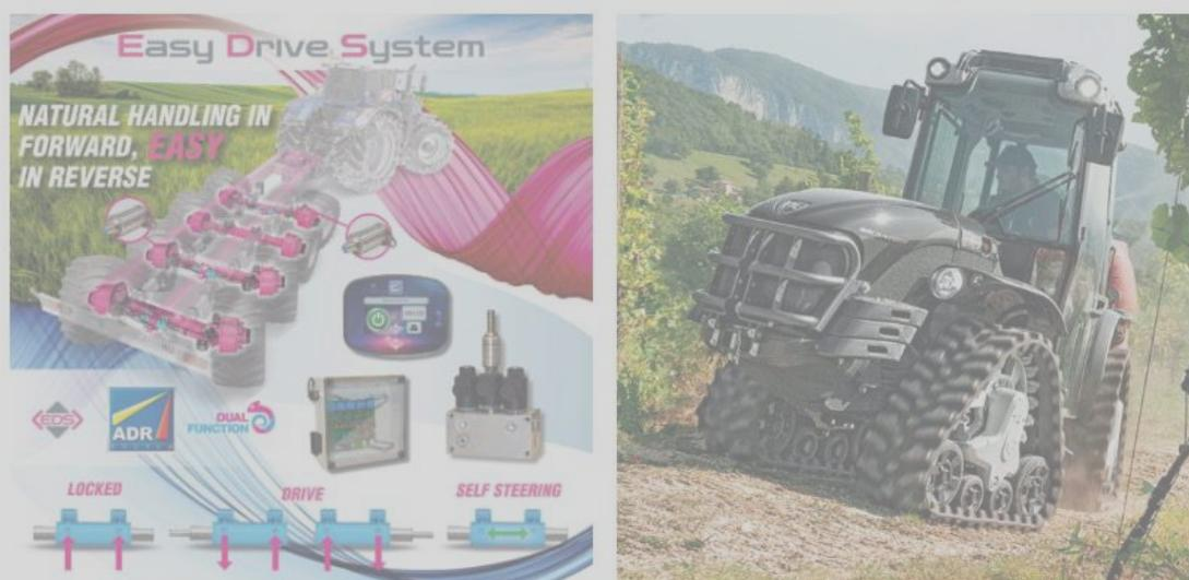
Novità Tecniche Eima 2022 il sistema EasyDrive di ADR, assale per rimorchio agricolo con possibilità di sterzata libera in avanti e servosterzo in retromarcia, a sinistra, e la trattrice stretta per vigneti e frutteti con cingoli in gomma, telaio articolato e trasmissione idrostatica Mach 4 Tony di Antonio Carraro, a destra.
