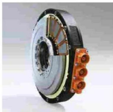
Un motore elettrico Yasa a flusso assiale. I rotori sottili e di grande diametro impediscono un regime di rotazione molto elevato ma danno una grande coppia. Il favorevolissimo rapporto volume/potenza ha convinto Ferrari ad adottarlo per le sue ibride e ha indotto Mercedes-Benz ad acquisire l'azienda
