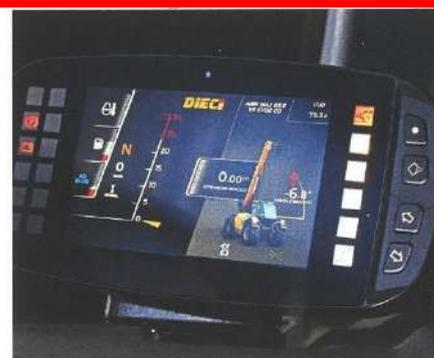
Il quadro di bordo **Idea** è adottato da **Dieci** sui suoi sollevatori telescopici **Agri Max** e **Agri Plus** per l'agricoltura, e **Apollo Smart** destinato al settore dell'edilizia
