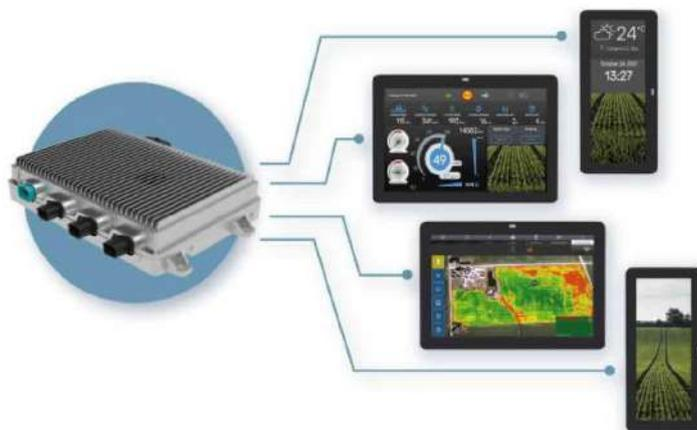
**Sistema HMI primario tra l'operatore e l'elettronica del trattore. È costituito da un'unità principale elettronica di controllo e da pannelli TFT separati.**
