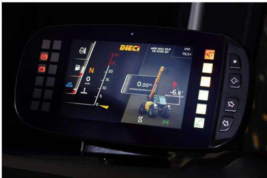
Molto robusto, alimentabile sia a 12 Vdc sia a 24 Vdc e perfetto per gli utilizzi sui telescopici **Dieci**: si tratta di **Idea**, il quadro di bordo off-the-shelf customizzabile tramite il software tool proprietario MTA Studio, che la multinazionale **MTA**, famosa per lo sviluppo e la produzione di un'ampia gamma di prodotti elettrici ed elettronici per il mondo automotive, fornirà a Dieci, primaria azienda produttrice di una vasta gamma di veicoli impiegati in agricoltura ed edilizia.
