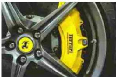
Pinza del freno Brembo montata su Ferrari 458 Italia
