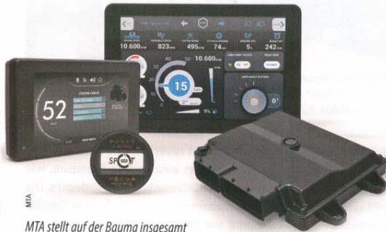
MTA stellt auf der Bauma insgesamt sechs Kombiinstrumente, vier Displays und zwei ECU in verschiedenen Formen und Größen vor. Versorgt werden diese via 12 V und 24 V.
